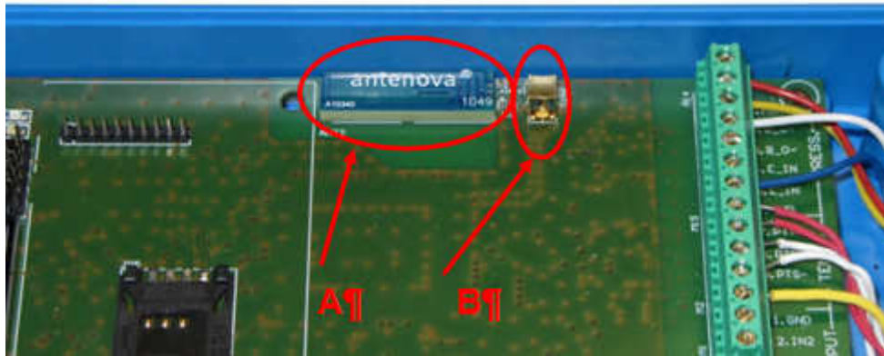
Fig. 16 – Antenna interna A, connettore per antenna esterna B
