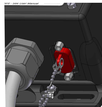
Fig.- 14 – Connessioni Seriale RS232 e tappo di protezione
